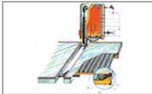
1976 Design of the vertical storage tank with open circuit system (100, 150 & 200 lt) • Σχεδιασμός συσκευής με κάθετη δεξαμενή ανοιχτού κυκλώματος (χωρητικότητα 100, 150 & 200 lt.)
